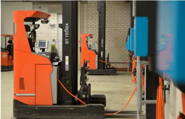
Li-Ionen-Technik ermöglicht ein schnelles Laden der Batterien. Dynamic Power Limitation (DPL) stellt sicher, dass dabei Stromspitzen vermieden werden.
